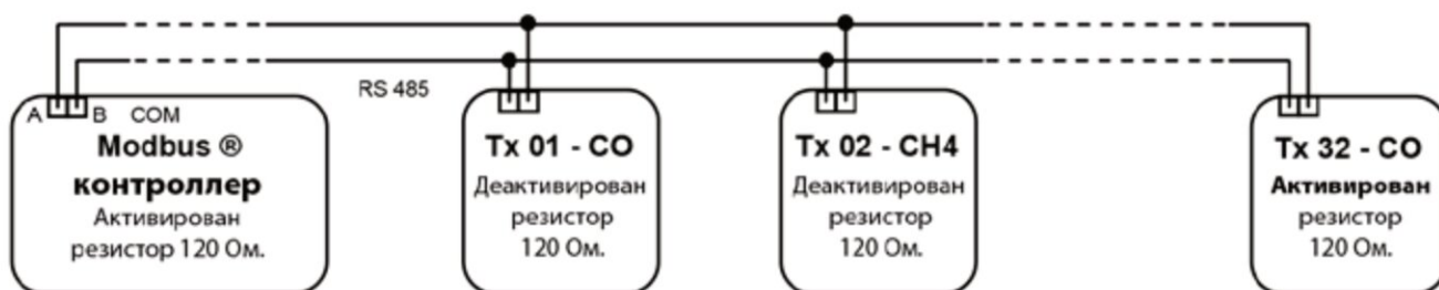
Пример 1: активированы резисторы на сенсоре и блоке.
