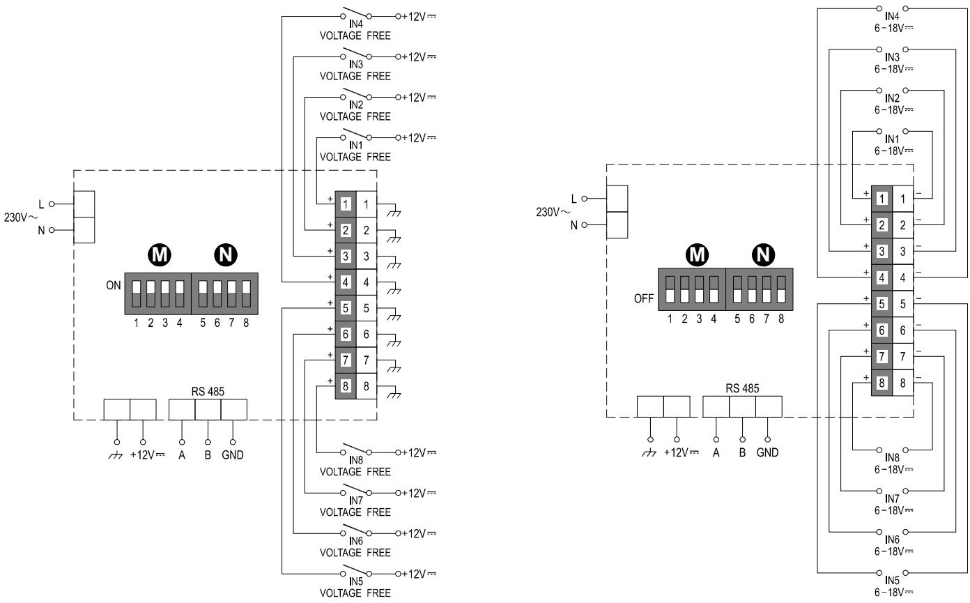
Рис.5: Схема подключения с входами без напряжения. Ползунки DIP-переключателей **М** и **Н**, установлены в положение ВКЛ.
