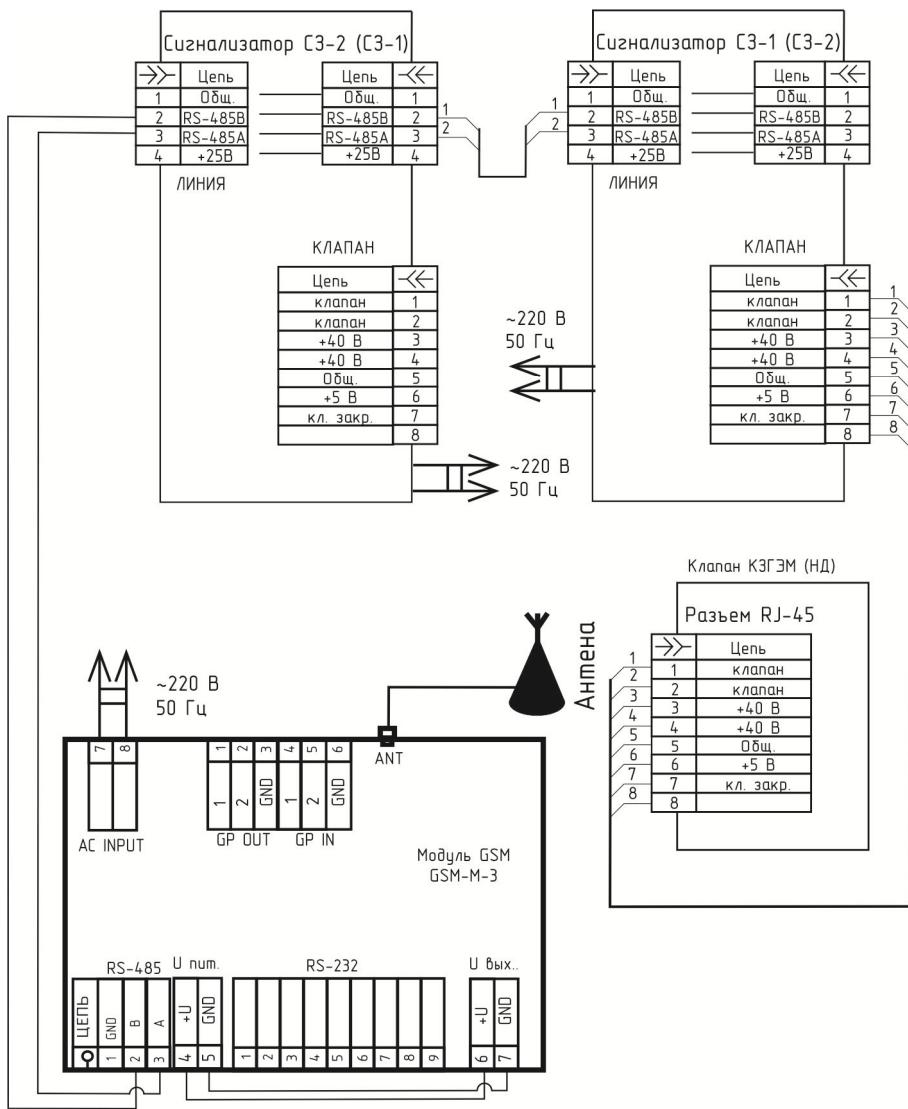
Рис 2. Схема подключения изделия к системе автономного контроля
