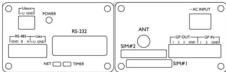
**Разъем питания модема от источника постоянного тока «Ubx» типа EDGRC15-2R**
