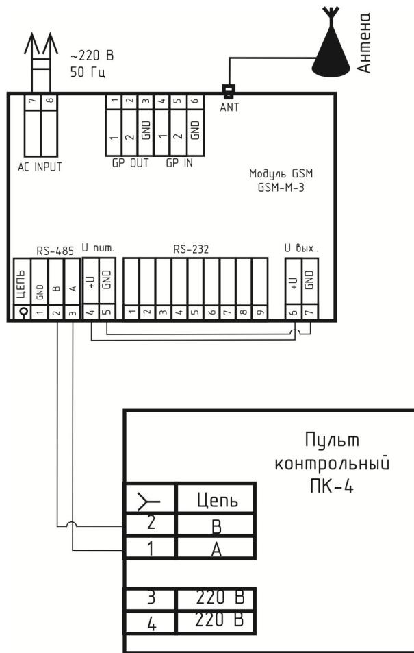
Рис 3. Схема подключения изделия-приемника к пульту контрольному ПК-4
