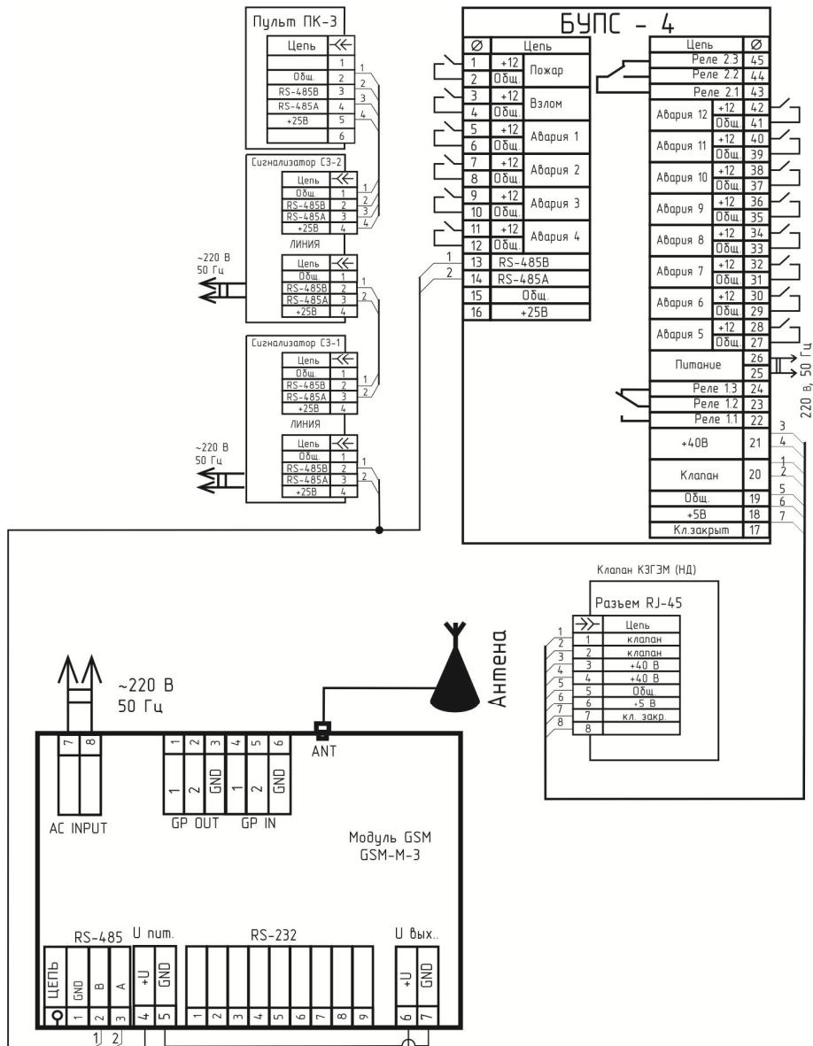
Рис 1. Схема подключения изделия к системе автономного контроля
