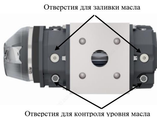
Рисунок 13 – Заливка и контроль уровня масла при установке счетчика G16-G400 на горизонтальном участке трубопровода
